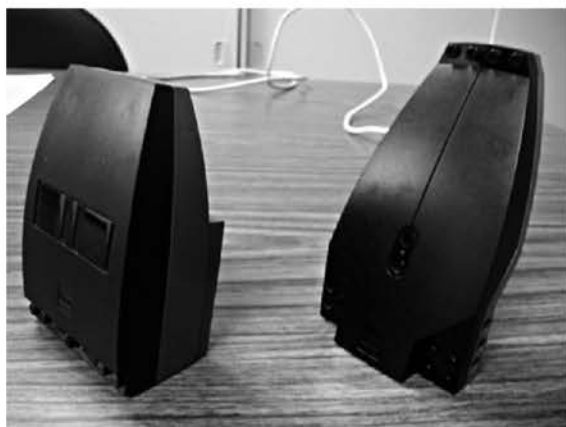
図2 IRタワー(左:RS232C,右:USB接続)
